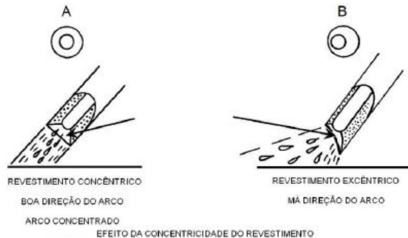
Figura 2 - Efeito da concentricidade do revestimento.
