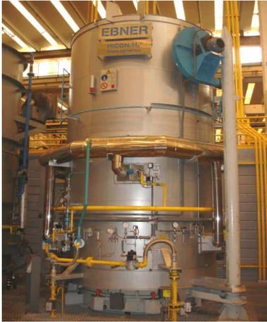
**Figura 6** - Forno de recozimento tipo sino
