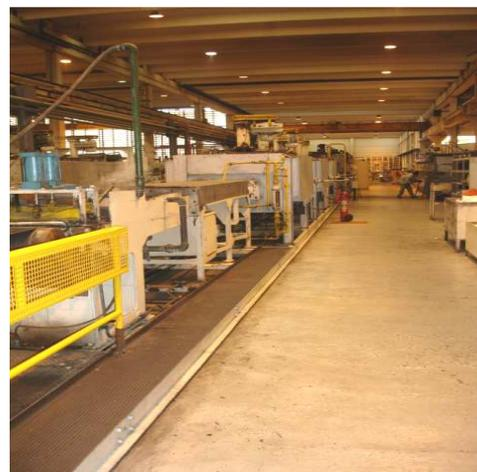
**Figura 9** - Forno de austêmpera
