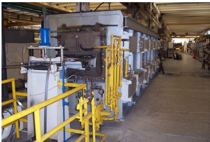
Fonte: Mangels Figura 1 – Forno contínuo de martêmpera.
