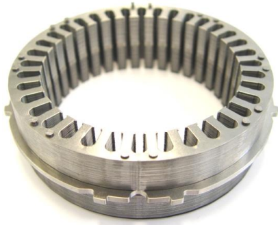
Figura 2: Modelo do pacote do estator desenvolvido neste trabalho. Seu processo de fabricação envolve estampagem em ferramental progressivo e posterior deformação em forma espiral para formação do pacote.
