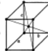
Ortorrômbico de Corpo Centrado (I)
